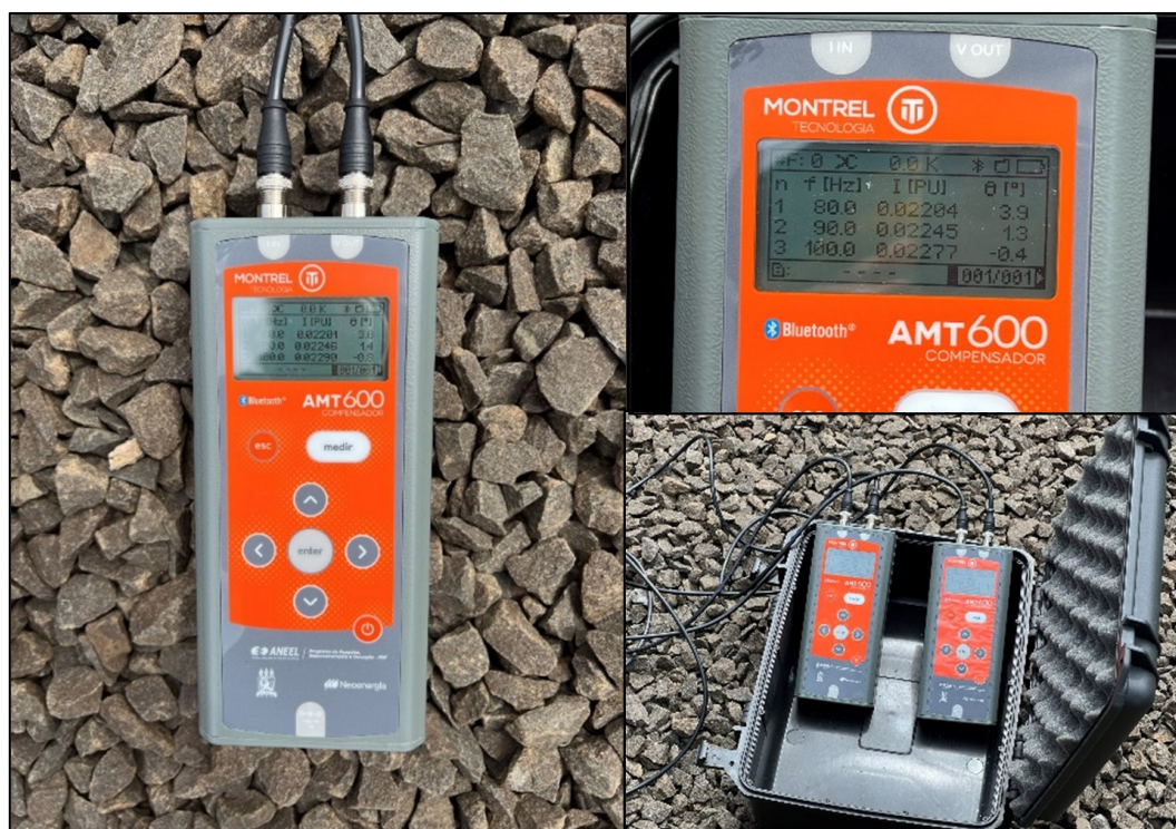
Figura 9 – Medição da corrente de compensação com o AMT600-Compensador.
