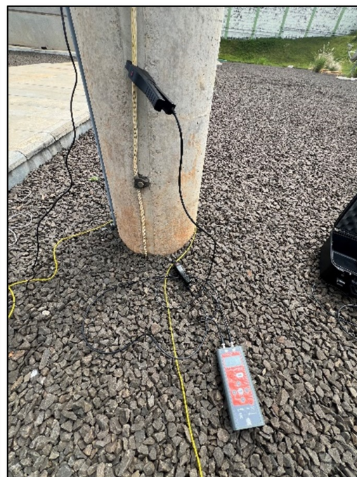
Figura 8 – Medição da corrente de compensação, SE Limeira-06.
