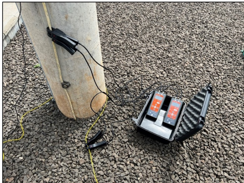
Figura 8 – Medição da corrente de compensação, SE Limeira-06.
